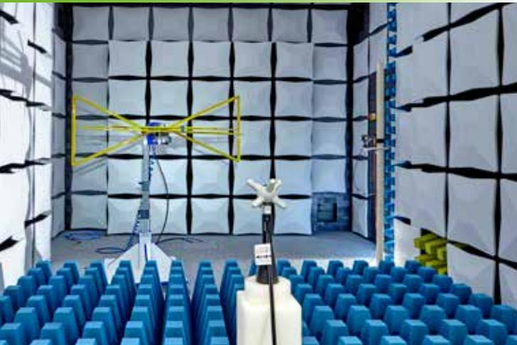
Sie als Kunde profitieren von unserer Prüfanlage in besonderem Maße. So entfällt durch den FAR der zeitintensive Höhenscan, welcher bei Teilabsorberräumen normativ vorgeschrieben ist. Zusätzlich sorgt unsere schnelle FFT-basierte Emissionsmessung dafür, dass eine Spitzenwertmessung über ein komplettes Frequenzband bereits nach kurzer Zeit abgeschlossen ist.
