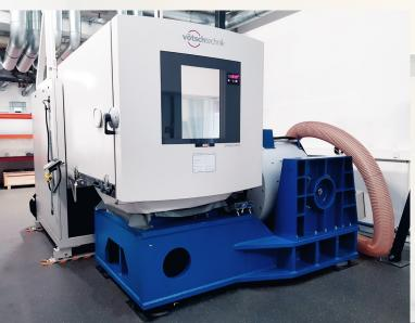
Schwingprüfungen als beachtenswerter Teil zum Nachweis für Produktzulassungen und als Prüfung in der Forschung und Entwicklung von Geräten und Bauteilen für den Automotive-Bereich, auf Schiffen und in der Bahntechnik sind nicht nur für die Zuverlässigkeit der Produkte vorteilhaft, sondern werden auch oft bei den OEM-Zulieferern benötigt. Ob mit kombinierten thermischen Tests oder unabhängigem Shaker ist das Schwingprüfsystem erste Wahl für Marktführer in den bedeutenden Bereichen der Industrie
